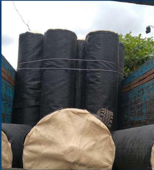
VERYTEX adalah Geotextile Woven dengan bahan utama pembuatannya dari jenis Polypropylene. Teknik pembuatan material ini adalah dengan cara dirajut dengan mesin canggih secara dianyam dengan metoda sulzer atau sulculair. Di area tanah yang kondisinya lemah terhadap gaya tarikan dan lemah terhadap tekan material ini difungsikan sebagai perkuatan (Reinforcement) serta difungsikan juga sebagai pemisah (Separator).
